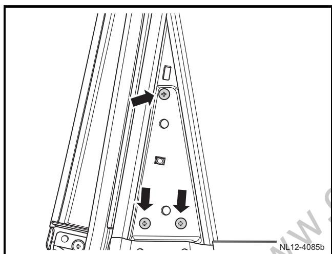
2) 拆卸外三角板背部的 3 个固定螺钉。
