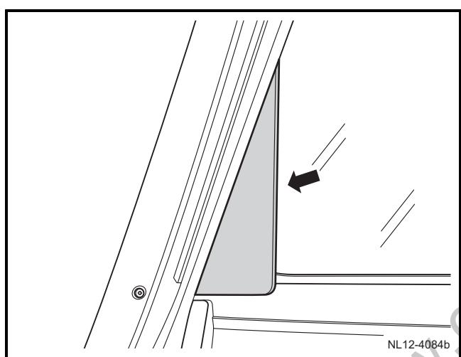
5) 接合内三角板的 2 个固定卡扣, 安装内三角板。
