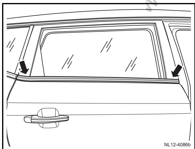
3) 拆卸车门玻璃外密封条的 2 个固定螺钉。
