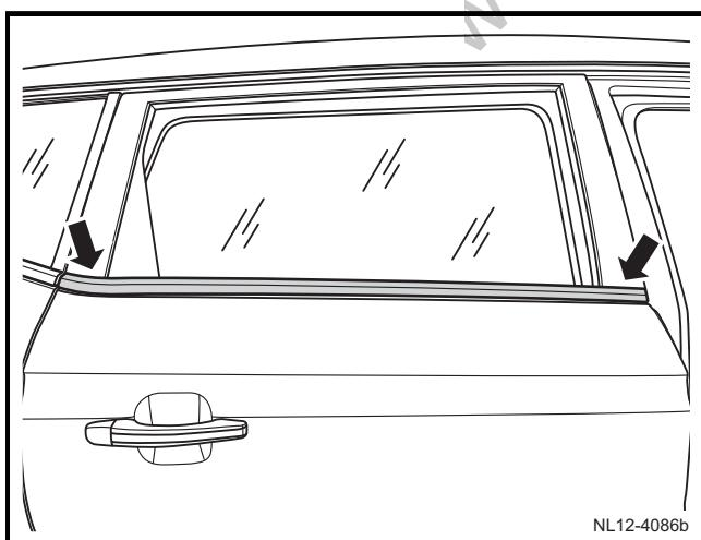
2) 安装车门玻璃外密封条。
