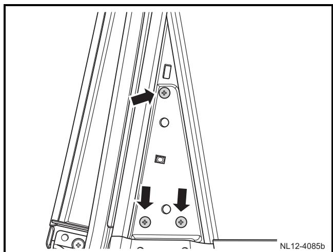
4) 安装后三角盖板背部的 3 个固定固定螺钉。
